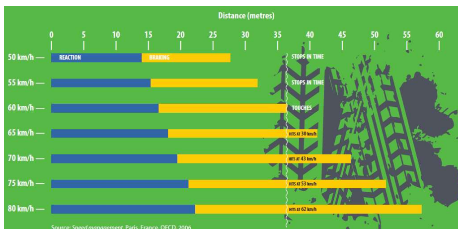
8. ábra – Féktávolságok és elütési sebességek a haladási sebességek mellett, 1 másodperc reakcióidő mellett
